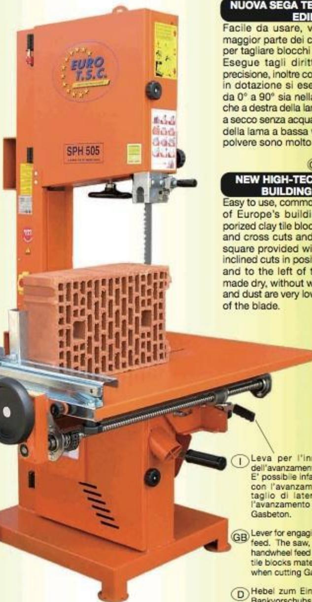
I Tramite il volantino con vite a ricircolo di sfera, il pezzo viene portato verso la lama con regolarità e precisione. Inoltre per regolarizzare l'avanzamento durante il taglio la macchina è dotata di giunto a frizione
