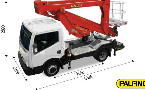
I dispositivi mostrati nelle foto presentano in alcuni casi allestimenti personalizzati e possono differire dall'allestimento standard. Nella costruzione è necessario rispettare le normative nazionali. Le dimensioni indicate non sono vincolanti. Con riserva di modifiche tecniche, errori ed errori di traduzione. PALFINGER PLATFORMS ITALY SRL
