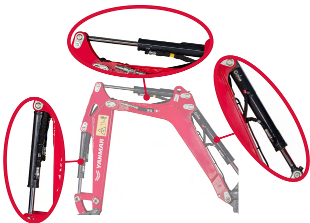
Cilindri montati sopra il braccio
